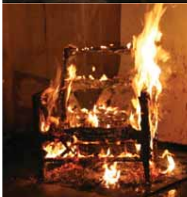
Bildene viser samme type lenestol utsatt for en mindre brannkilde. Den øverste stolen tilfredsstiller brannkravene i Storbritannia, den nederste dagens brannkrav i Norge. Foto: SINTEF NBL.
