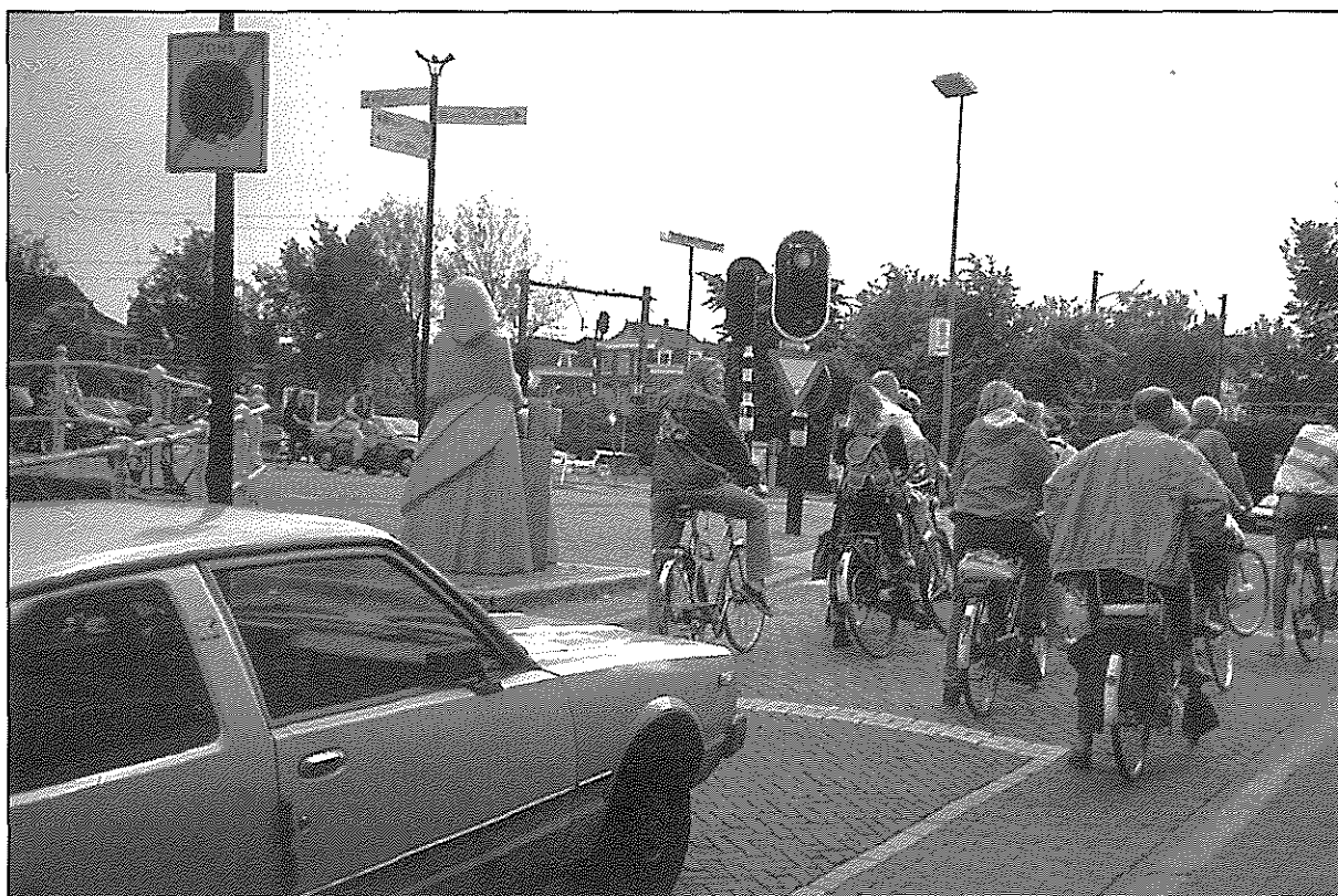
I Delft i Nederland har syklistene en egen «sykkelboks» foran stopplinjen for bilene for å gi syklis- tene fortrinnsrett i krysset. (Foto: Gustav Nielsen)
