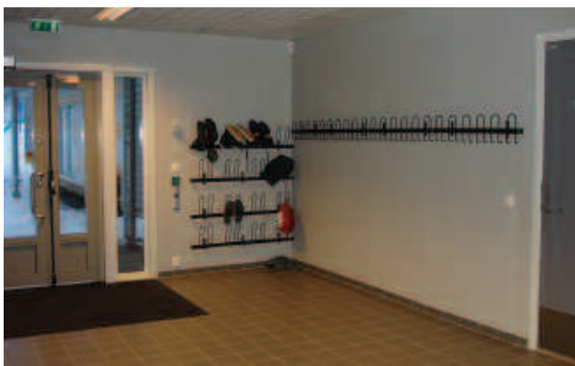
Eksempel på fargeforskjell mellom gulv og vegg og mellom vegg og dør. Dette gir god romoppfattelse.
