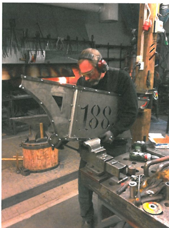
Ny vindfløy til spiret på Edøy kirke.
