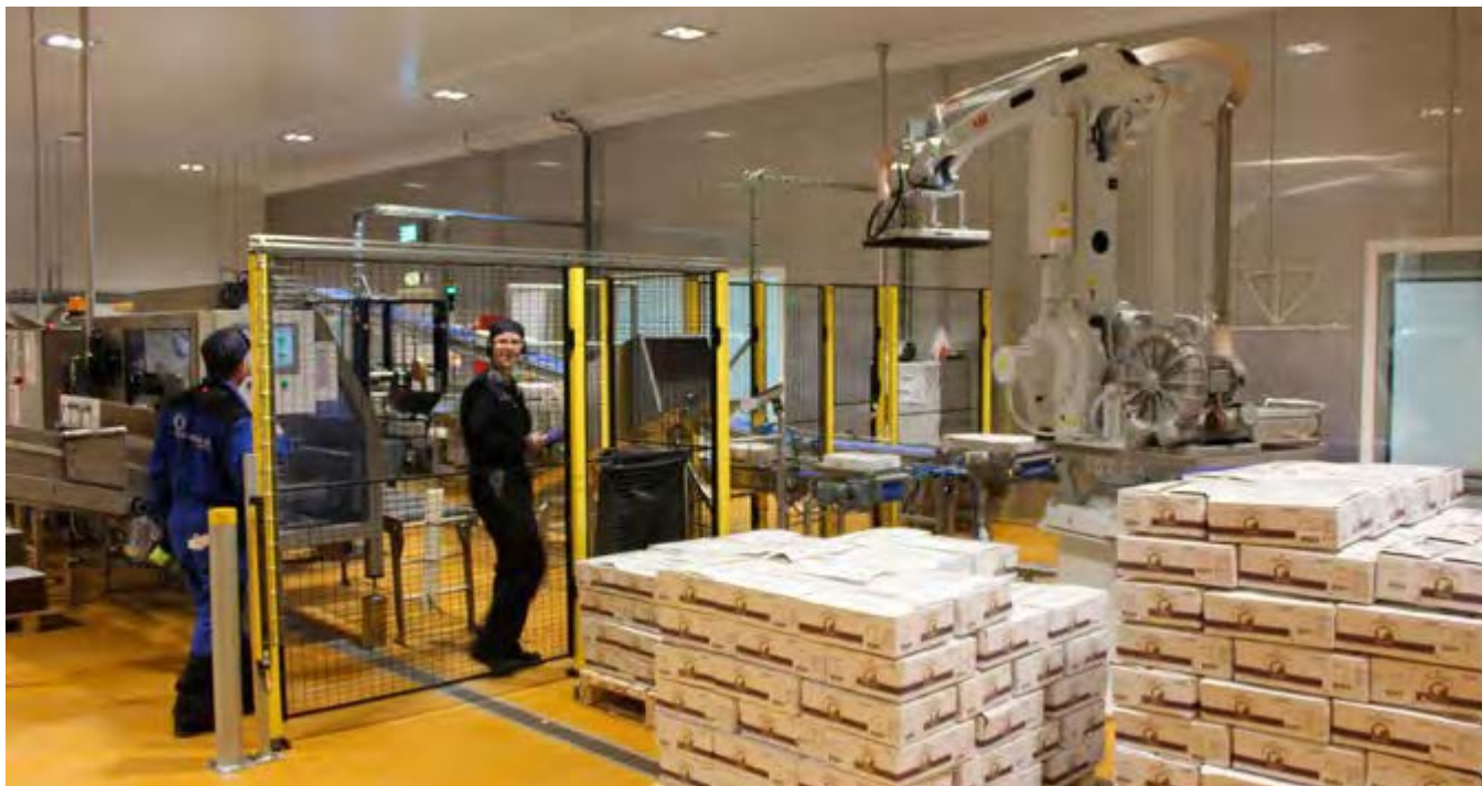
ROBOT I FISKEFOREDLINGSANLEGG , Automatisering er på full fart inn i sjømatnæringen. Her fra Brødrene Karlsen på Husøy utenfor Senja der en robot erstatter to personer som tømte omlag 30 tonn laks per dag. Automatiseringsprosjektet er et samarbeid mellom campus Narvik (Universitetet i Tromsø), norske og svenske leverandører og studiesenteret på Finnsnes. Skattefunn har vært brukt til å lette finansieringen. FOTO: VINCENT FLEISCHER, KMD
