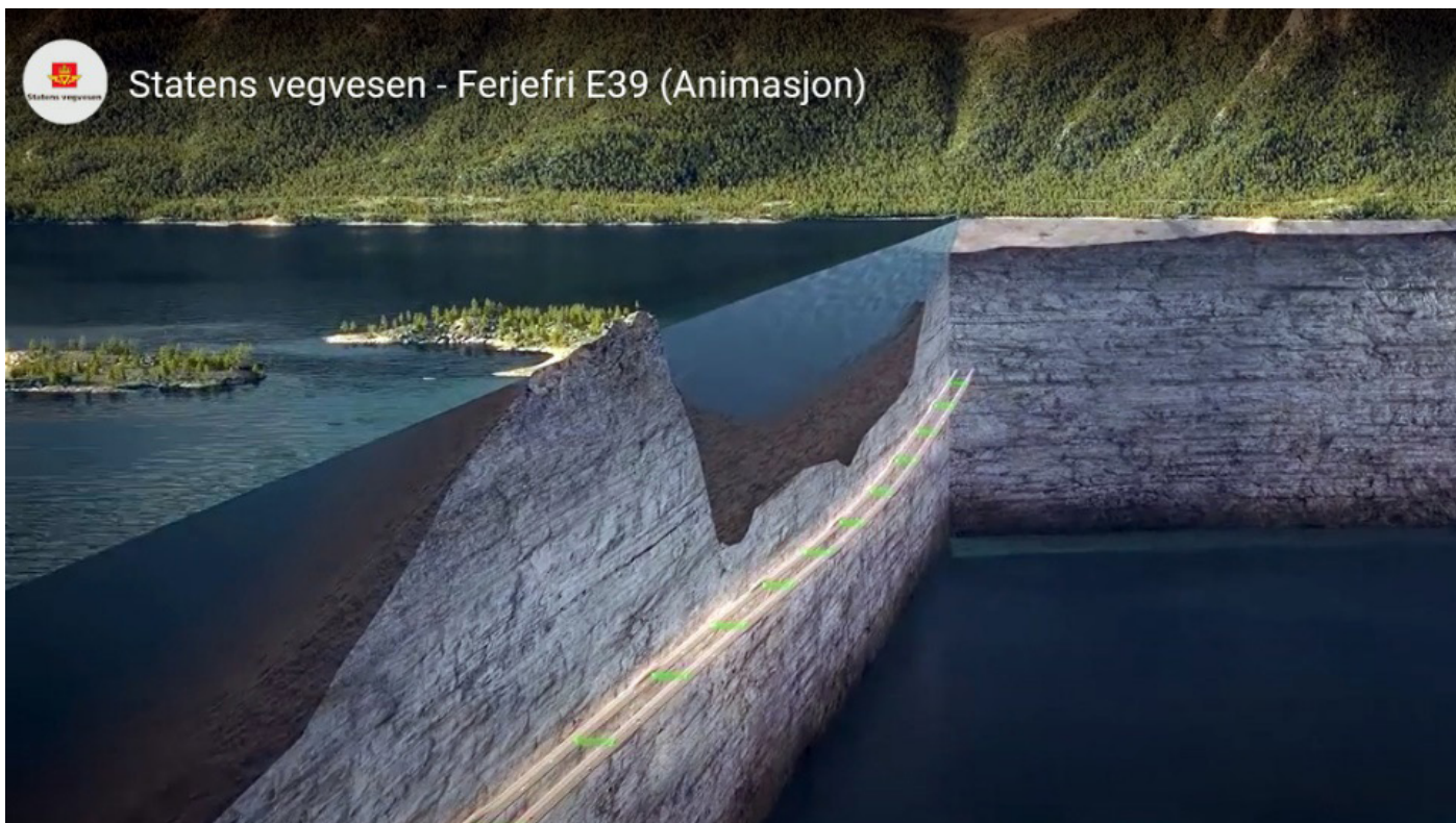
Figur 3.6 (Statens Vegvesen): Illustrasjonen fra Statens vegvesen viser hvordan tunnelen er planlagt å krysse under Romsdalsfjorden.
