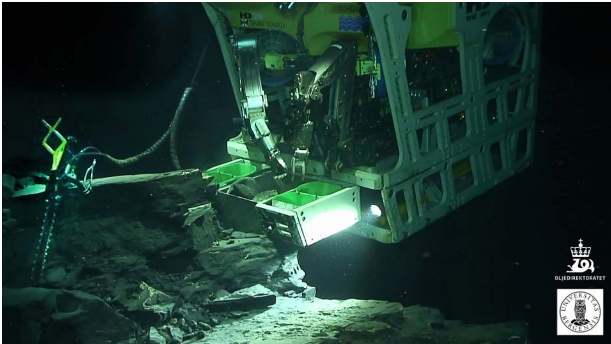
Bilde 7. Prøvetaking utført av Oljedirektoratet i 2013 på Vøringsutstikkeren, 3 000 meters vanddyp. Til venstre fjernstyrt motorsag for å sage løs steinprøver. (Foto: Universitetet i Bergen)
