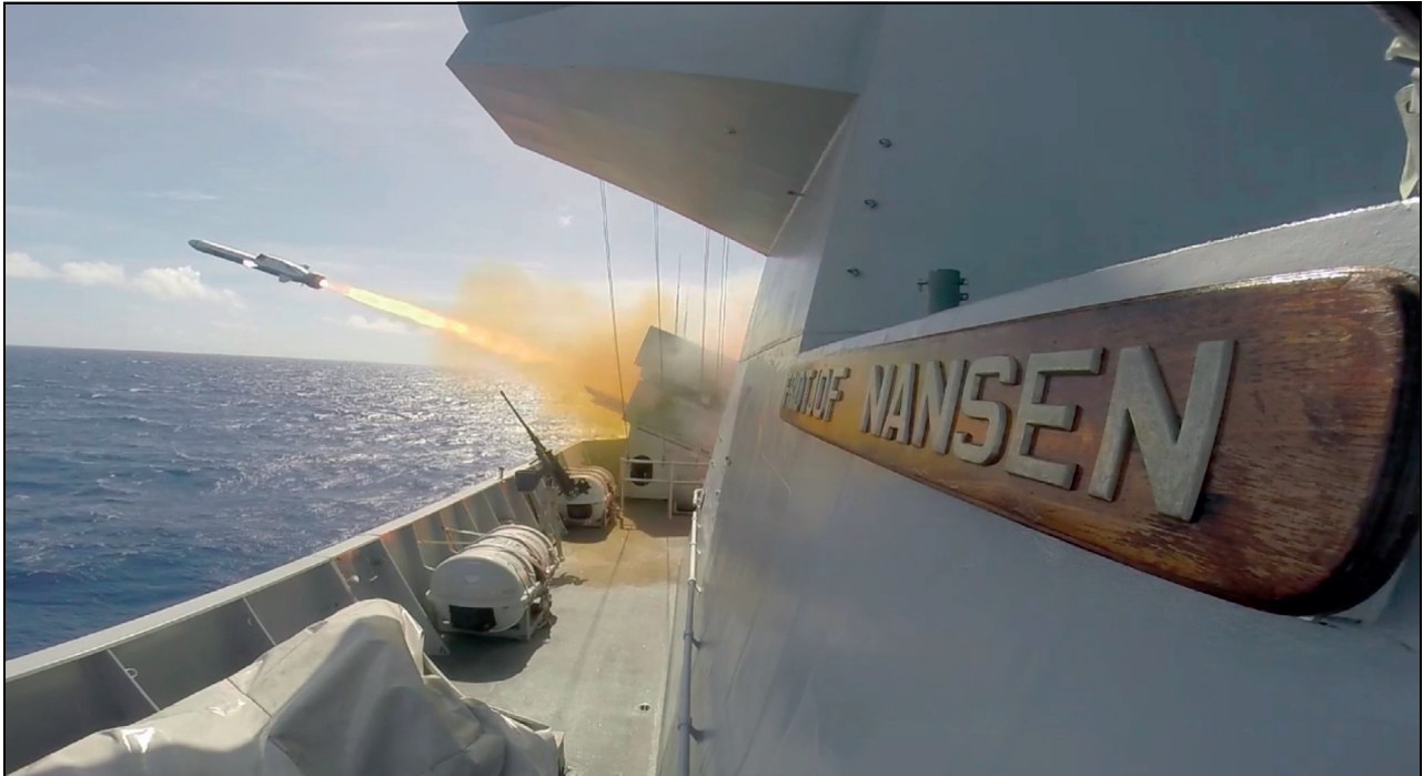
Figur 5.2 Missilet NSM er utviklet i Norge. Både Nansen-klassen fregatter og Skjold-klassen korvetter har dette missilet som sitt hovedvåpen mot overflatemål.
