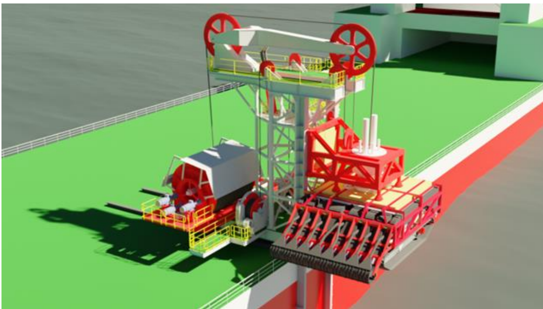
Figur 68 IHC's LARS løsning for tungt utvinningsutstyr. Kilde: Royal IHC
