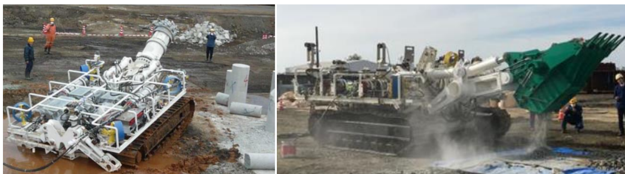
Figur 30 Testing av utvinningsutstyret med to belter og kutterhode (venstre) og det samme utstyret der kutterhodet er erstattet av en kjefteknuser (test på land; høyre). Bilder gjengitt med tillatelse fra JOGMEC.
