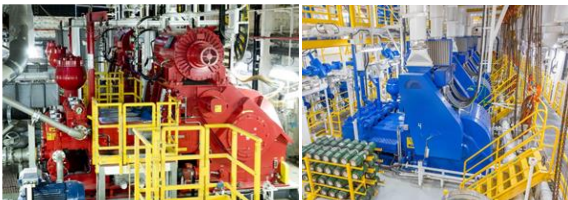
Figur 63 Slanpumper for olje & gassboring. Kilde: MHWirth (venstre) / NOV (høyre)
