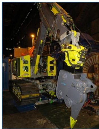
Figur 37 Ulike utskiftbare mulige verktøy for REN Spideren som forslagsvis kan brukes i utvinning av mineraler fra havbunnen. De er designet for forskjellige jobber og brukes hovedsakelig tilknyttet til fornybar energi og O&G-operasjoner. Med tillatelse fra RenOcean.
