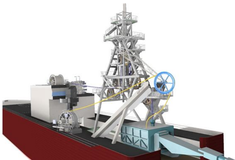
Figur 55 LARS (Launch and Recovery System) utviklet for De Beers' diamantutvinningsfartøy AMV3. Kilde: AXtech
