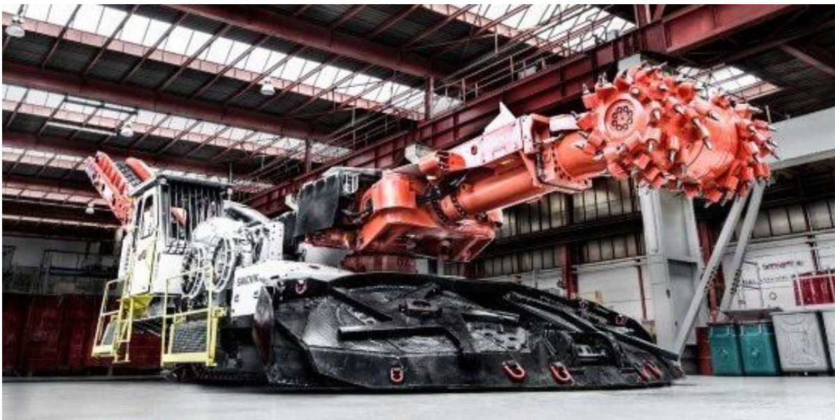
Figur 36 Bilde som viser en Roadheader med et geometrisk optimalisert kutterhode, som er designet for å kontinuerlig grave ut veier, tunneler etc. (bilde med tillatelse fra Sandvik).
