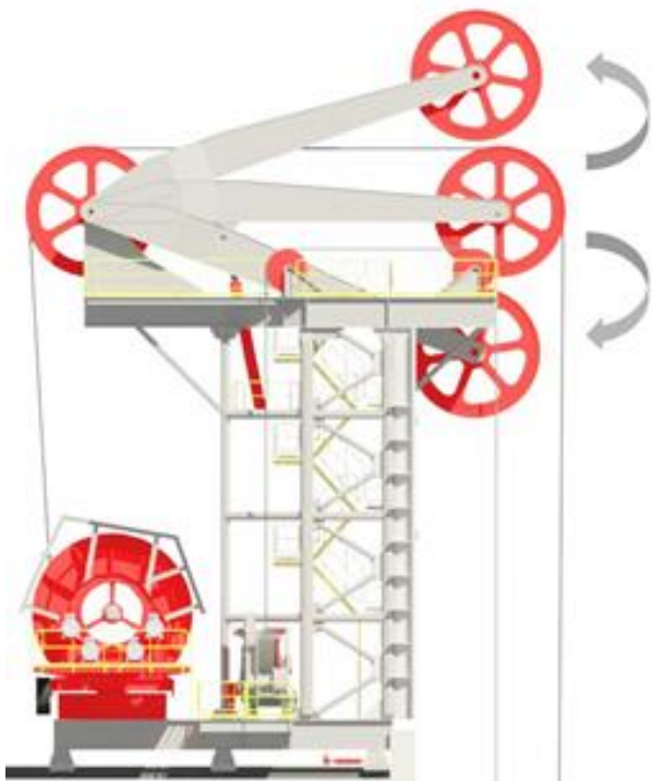
Figur 58 Illustrasjon av LARS utviklet for utvinning av havbunnsmineraler på store dyp. Kilde: Royal IHC
