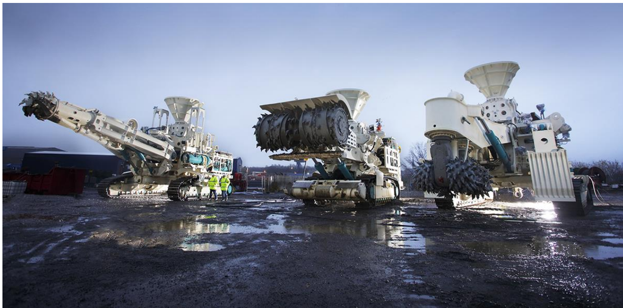
Figur 27 Tre typer maskiner designet og bygget av SMD for Solwara 1 DSM-prosjektet til Nautilus Minerals: The Collecting Machine (til venstre), "Bulk Cutter" (i midten) og "Auxiliary Cutter" (til høyre); med tillatelse fra Deep Sea Mining Finance Limited 17 .
