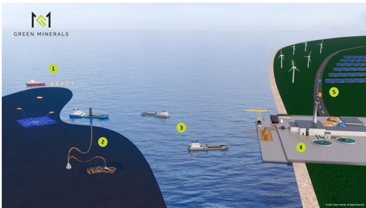
Figur 41 Green Minerals konsept for utvinning av havbunnsmineraler. Tallene på figuren viser: 1. Leting, 2. Utvinning / Produksjon, 3. Offshore logistikk (fartøyer etc.), 4. Prosessering av malmen, 5. Levering til sluttbruker (f.eks. batterifabrikk). Illustrasjon med tillatelse fra Green Minerals AS.
