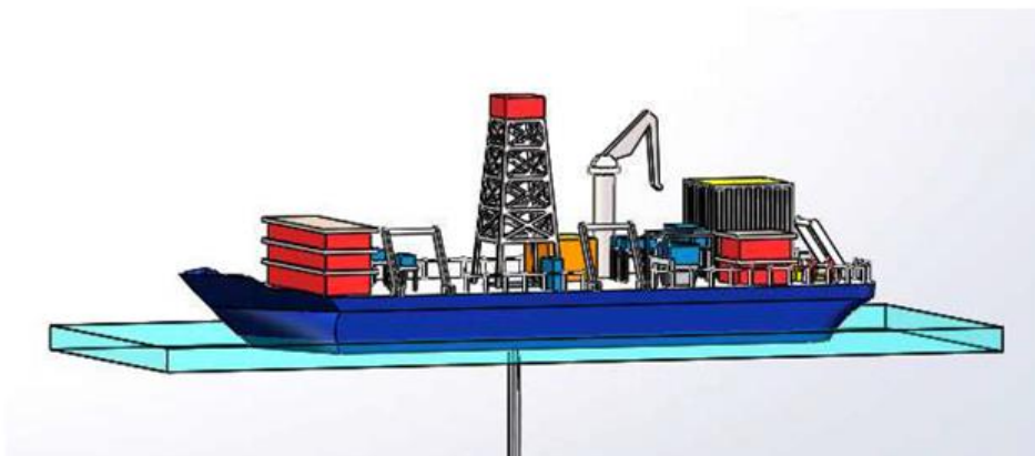
Figur 53 Illustrasjon av et fullt integrert produksjonsfartøy. Kilde: 2H Offshore
