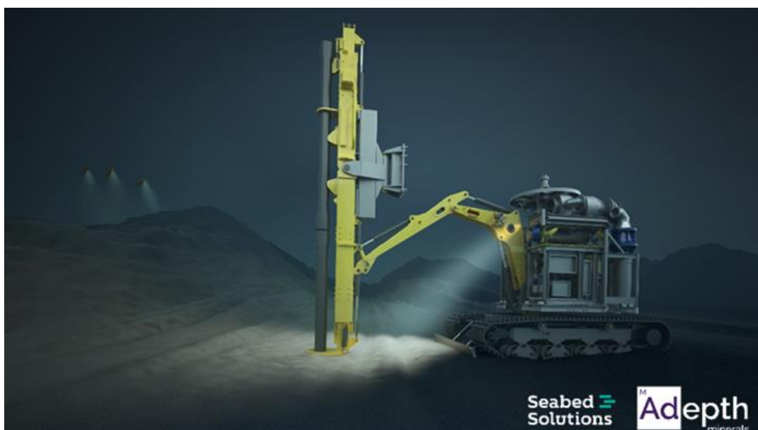
Figur 40 Det egenutviklede kjerneprøvetakingsutstyret (med tillatelse fra Seabed Solutions og Adepth Minerals).
