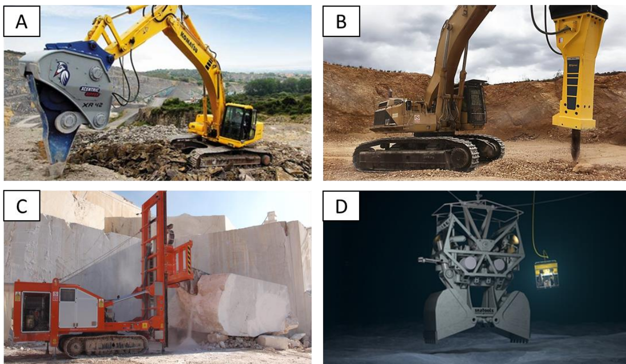
Figur 17 A: gravemaskin utstyrt med en hydraulisk ripper (med tillatelse fra XCentric 8 ); B: gravemaskin med hydraulisk hammer (bilde med tillatelse fra Epiroc 9 ); C: sagemaskin (med tillatelse fra Fantini 10 ); D: utgravningsgrabb på dypt vann (med tillatelse fra Seatools 11 ).
