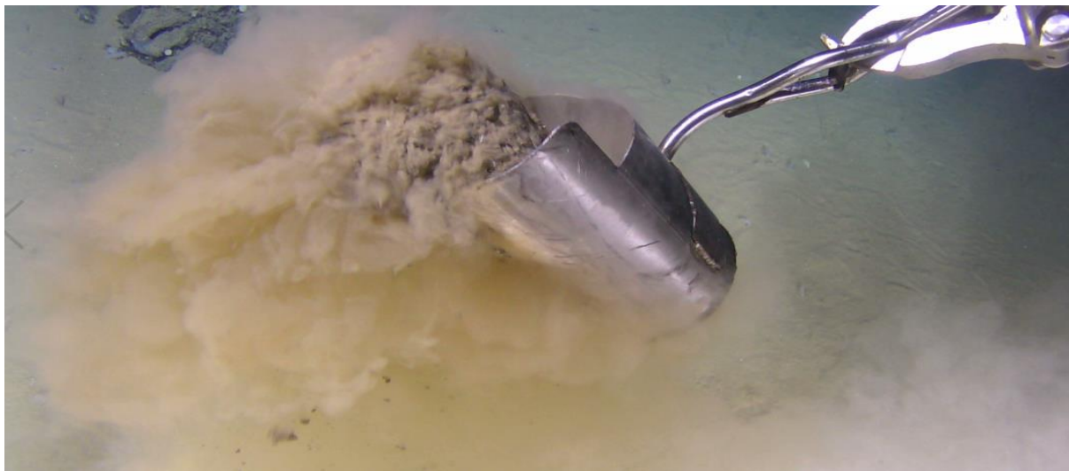
Prøvetaking med skuffe av bløte havbunnsedimenter
