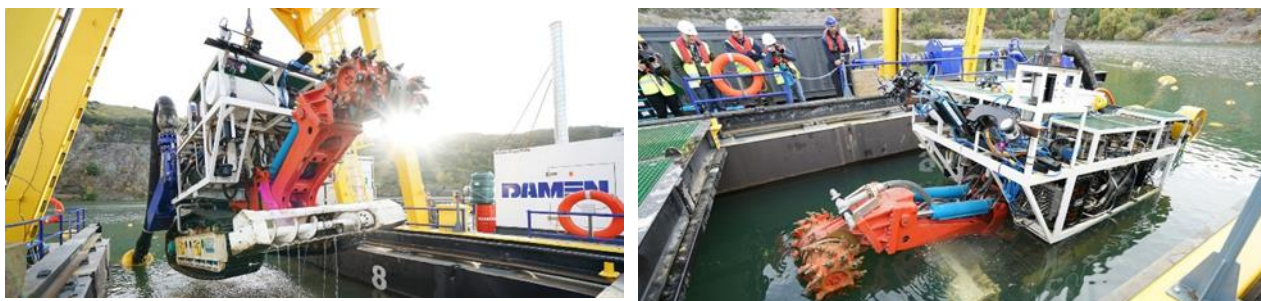
Figur 18 Testing av skjæreverktøy for mineralutvinning under vann (tester gjennomført vått på land) av SANDVIK i EU-prosjektet VAMOS! (2017).
