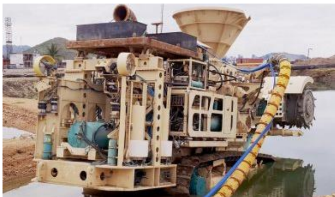
Figur 19 Testing av bulkkutteren designet for Solwara 1-prosjektet til Nautilus Minerals. Kilde: Nautilus Minerals / DSM Observer 12 .
