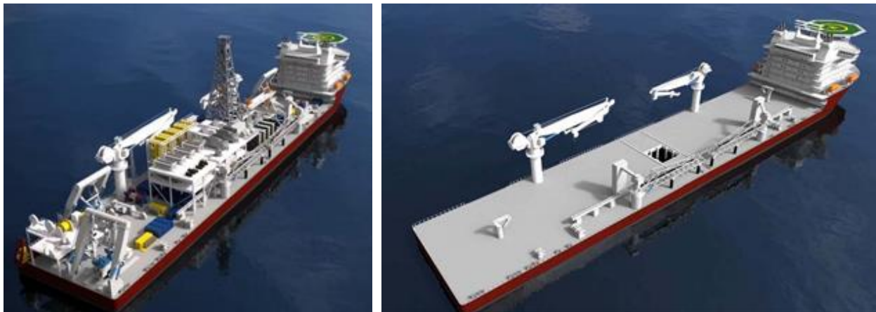
Figur 59 Illustrasjon av krananordning på produksjonsstøttefartøyet til Nautilus Minerals som ble designet for utvinning av sulfider. Kilde: Nautilus Minerals
