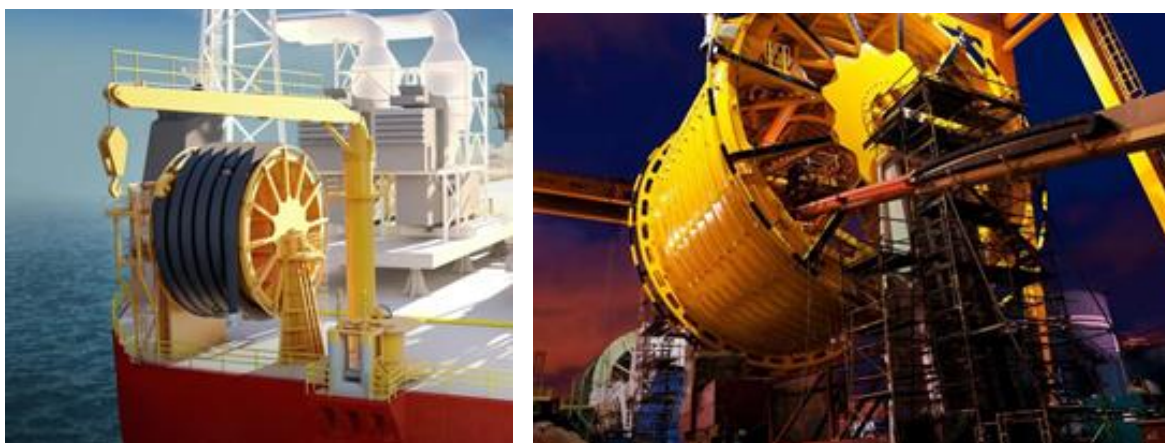
Figur 64 Lossekonsept basert på flytende slange. Kilde: NOV APL
