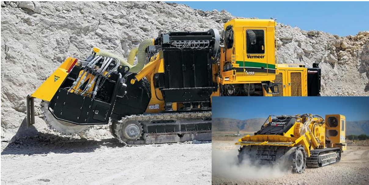
Figur 35 En «surface miner» som brukes i utvinning i dagbrudd (bilde med tillatelse fra Vermeer).
