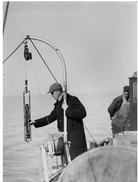
Figur 1.2 Forskningsskipet Michael Sars I , brukt mellom 1900 og 1914 (fotograf ukjent) og måling av saltholdighet og temperatur ved hjelp av vannhenter (fotograf: Alf Dannevig).
