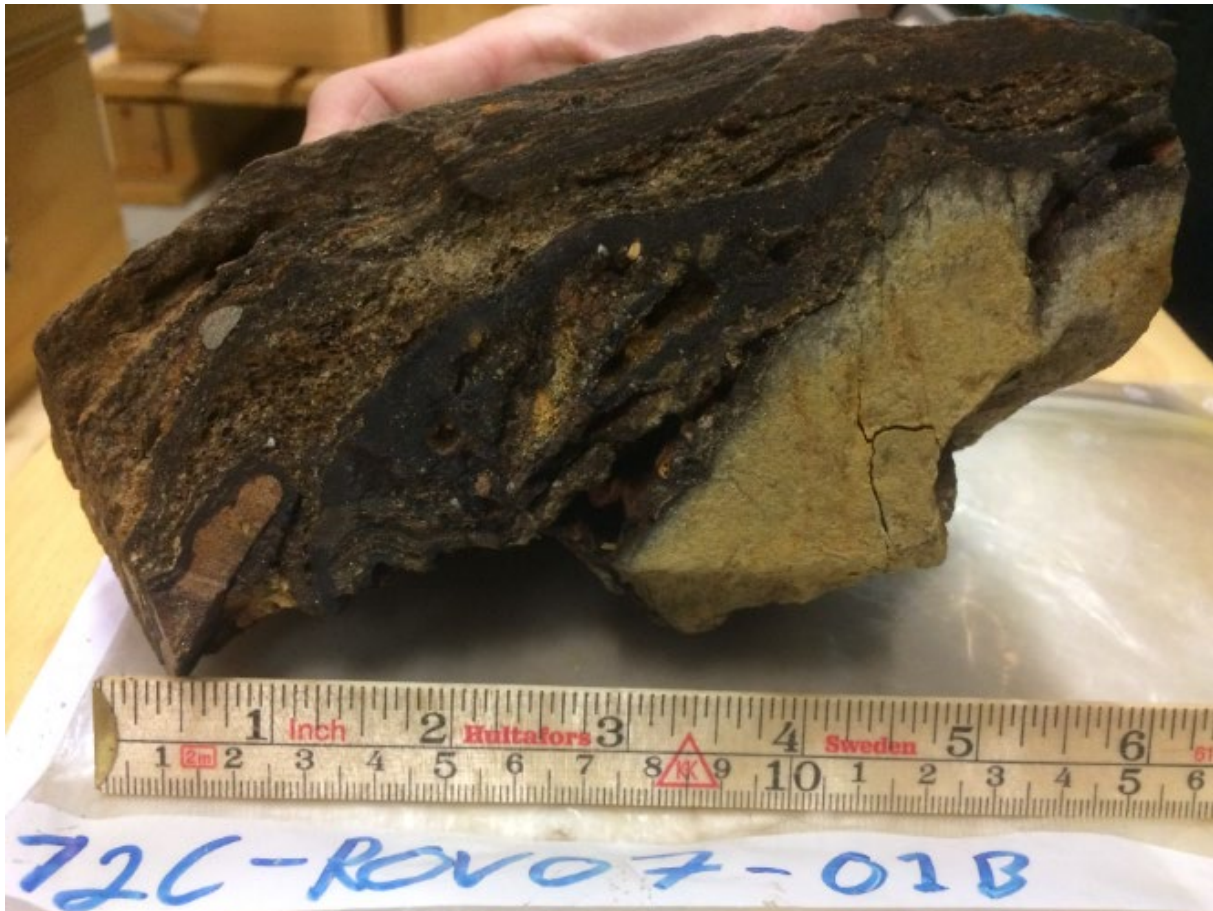
Figur 4-5. Den mørke delen av prøven på bildet viser manganskorpe som har vært avsatt på den lysere bergarten, som i dette tilfellet er leirstein. Kilde: Oljedirektoratet.
