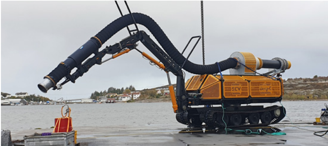
Figur 4.7 Typisk sugetraksenhet (ejektorpumpe) Kilde: DeepC
