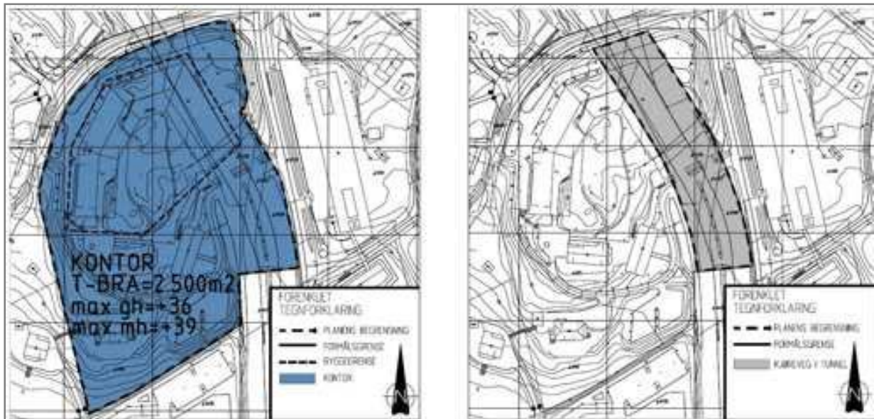
Figur 1-10: Eksempel på utsnitt av plan over flere vertikalnivå (tegnforklaringen er ikke fullverdig).
