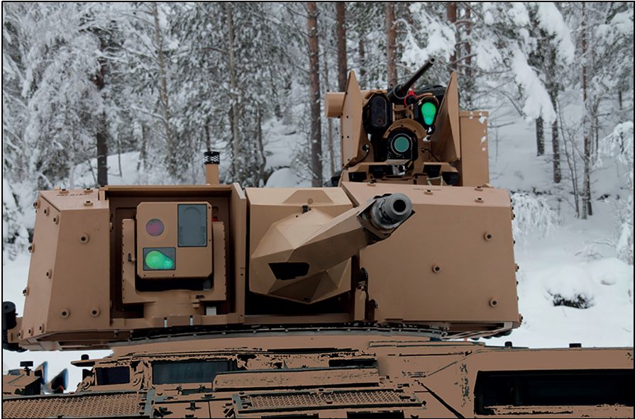
Figur 1.4 Våpenstasjonen Protector kan fjernstyres med høy presisjon fra en lukket vogn, noe som både bidrar til å beskytte operatørene og unngå utilsikket skade.
