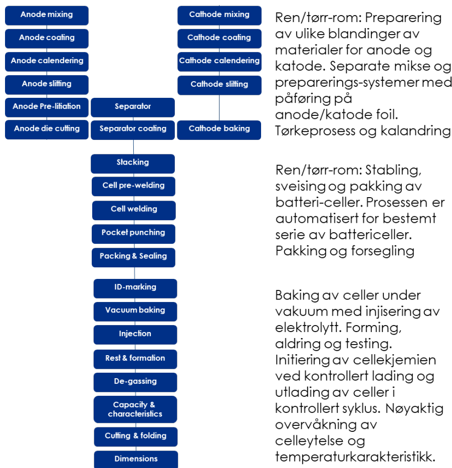
Figur 15 - Prosessflyt i battericelleproduksjon - eksempel på posecelleproduksjon
