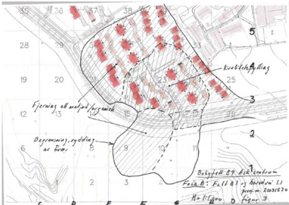
Figur 5.21 Fylling lagt ut i Nystulia for bygging i B9. (NGI, 2005b)
