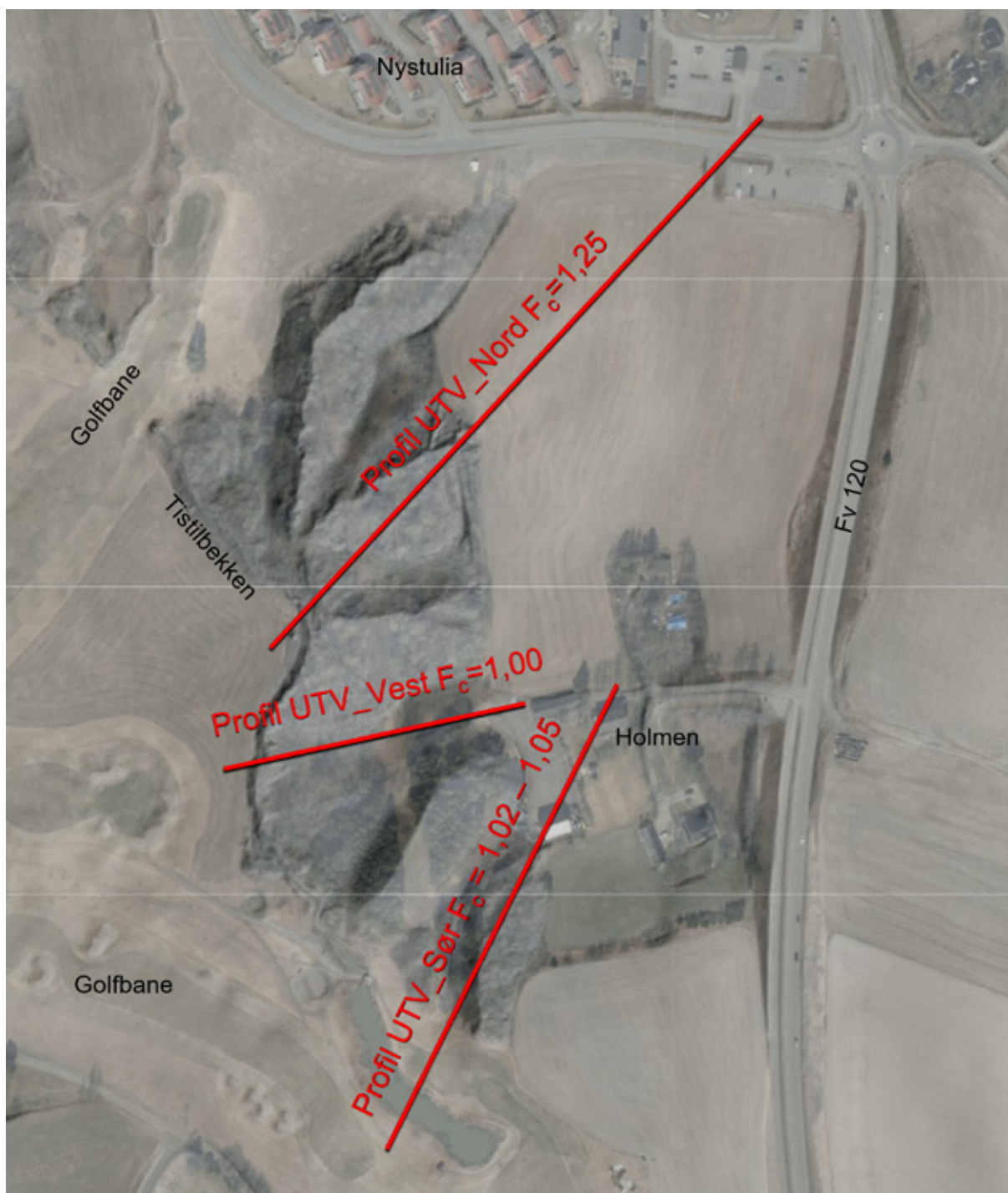
Figur 5.16 Profiler for stabilitetsanalyser utført av utvalget (UTV) med beregnede sikkerhetsfaktorer fra udrenerte analyser
