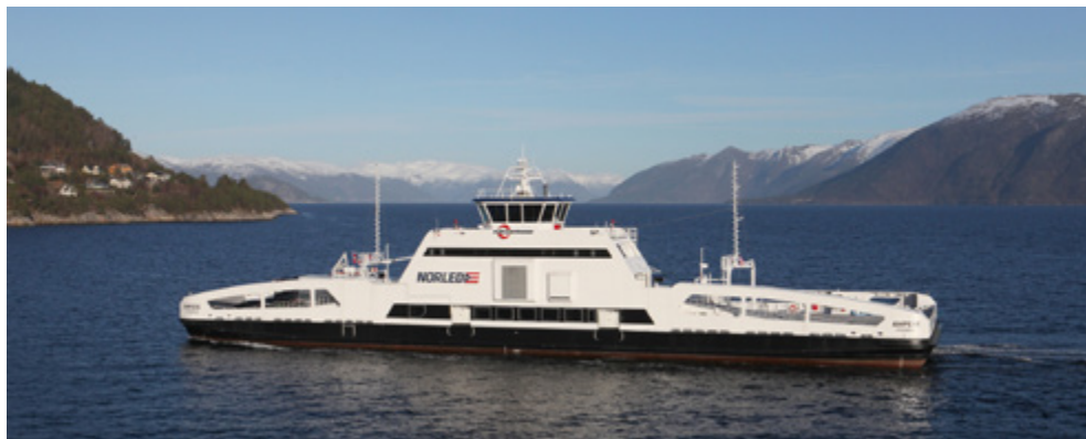
Siden 2015 har Ampere, verdens første batteridrevne ferge, krysset Sognefjorden mellom Lavik og Oppdal. Foto: Norled
