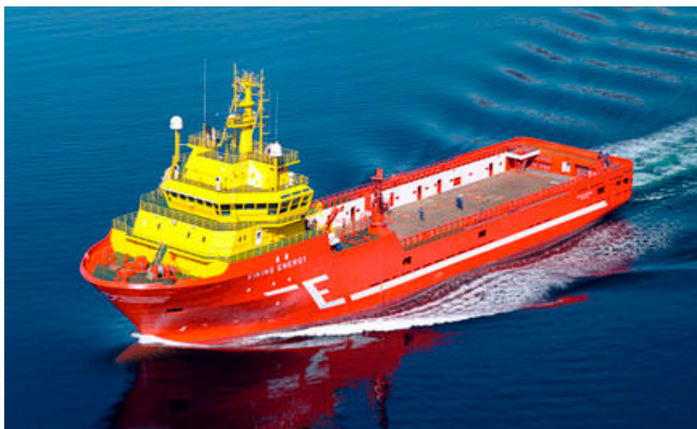
Eidesviks forsyningsskip Viking Energy var første offshorefartøy med LNG- motor i 2003. I 2016 var skipet igjen først med en avansert batteriinstallasjon som per år har redusert drivstofforbruket med 17 prosent. Batterisystemet har en kapasitet på 650kWh og omformer/kraftelektronikk som gjør at det kan levere 1600kW. Foto: Eidesvik Offshore
