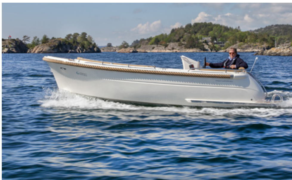
«GreenWaves 601» er en norsk, helelektrisk fritidsbåt, med 7,5 kW motor. Standard lithium-batteripakke gir 5-7 lydløse timer på sjøen. Foto: Johner Bildbyrå AB
