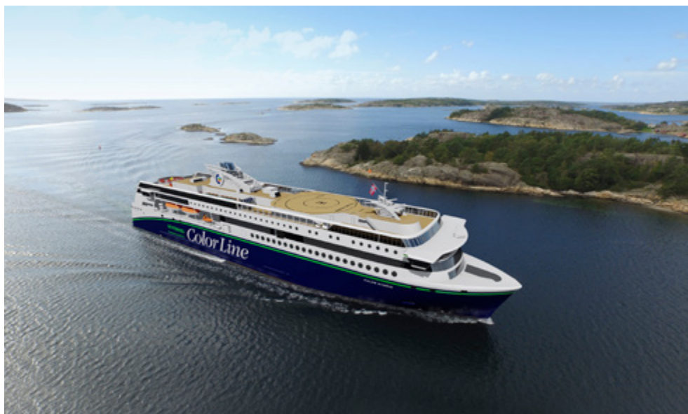
Color Line får det som blir verdens største hybride passasjerferge når Color hybrid leveres fra Ulstein verft neste år. Med batteripakken på 4,7 MWh skal Color Hybrid kunne seile 3,2 nautiske mil kun på strøm fra batterier, ladet med strøm i Sandefjord i løpet av nattoffholdet. Foto: Fosen Yard/Ulstein
