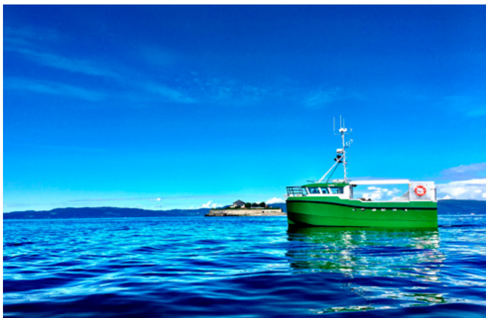
Karoline er verdens første hybridsjark med elmotor. Det snaut 11 meter lange fartøyet bruker dieselgeneratorer til og fra fiskefeltet. Batteriet forsyner skipet med nok kraft til to timer fiske og 45 minutter framdrift. Foto: SIEMENS
