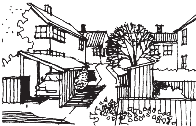
Sekundærbygg brukt til å forsterke romfølelsen
