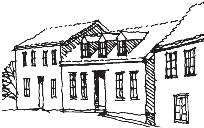
Gesims og takoppbygg viktig for husets uttrykk
