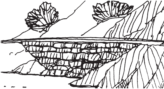
Fylling med bevisst materialutførelse
