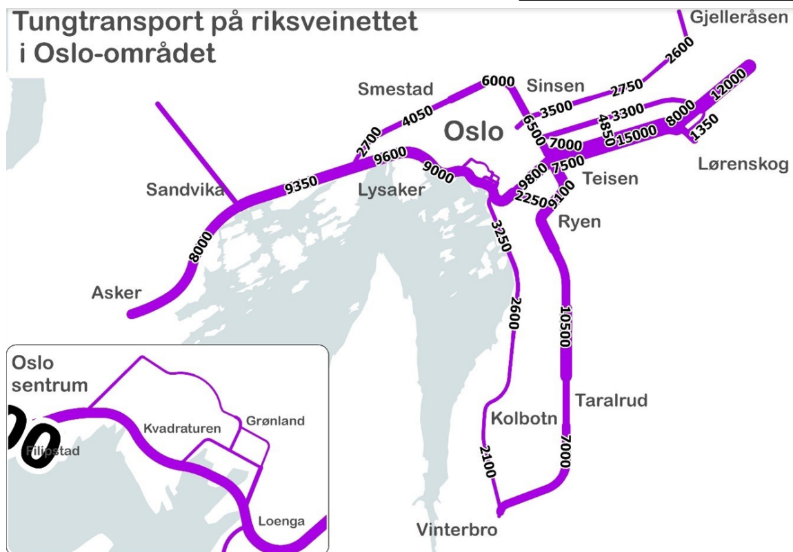
Figur 42: Tungtransport på riksveinettet i Oslo-området, målt i ÅDT (årsdøgntrafikk).
