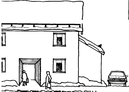
§ 7-45 fig 1 og 2 Nedfall fra tak må forhindres
