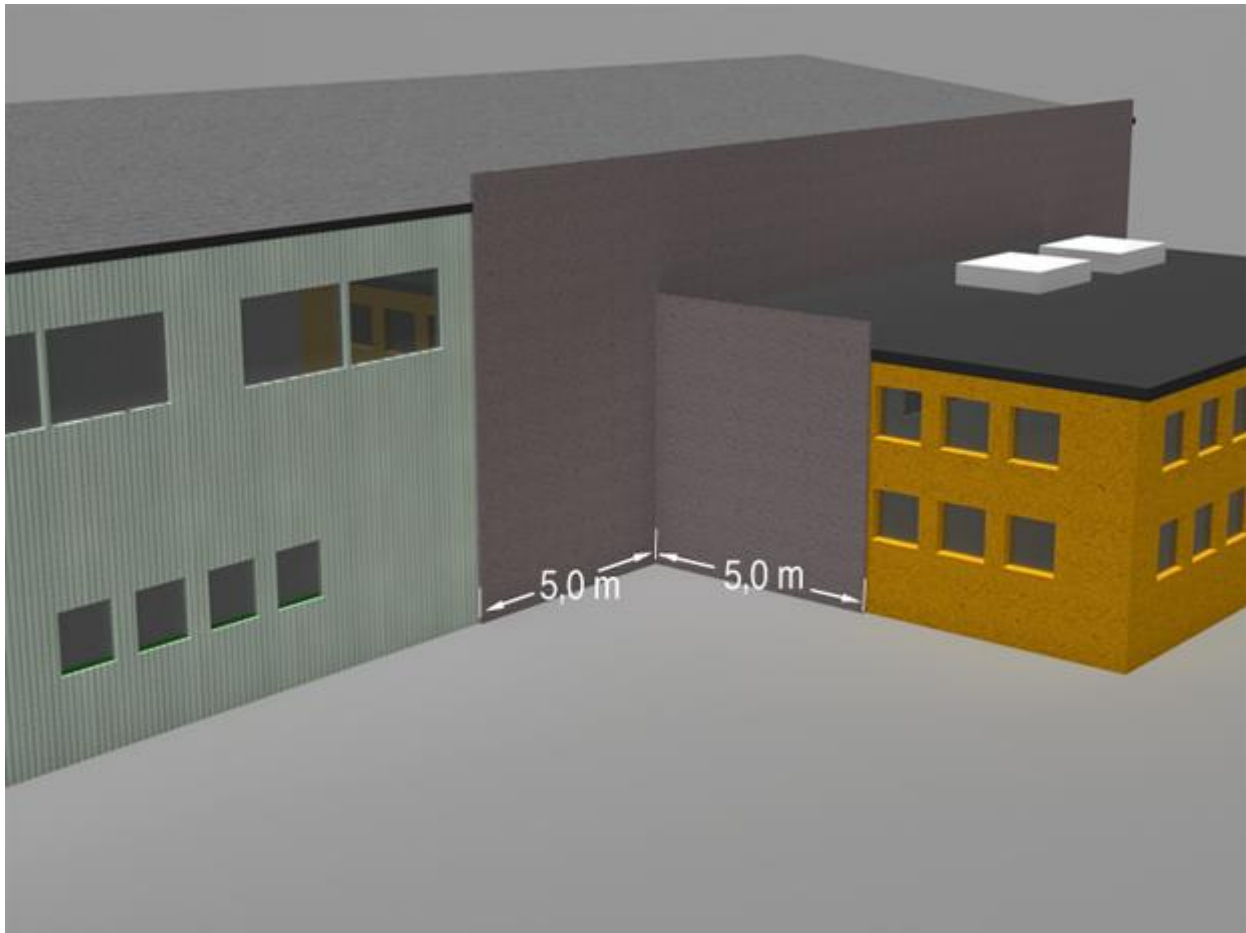
§ 11-7 Figur 1b: Utforming for å hindre brannsmitte fra vegg til vegg i innvendige hjørner. Alternativ 2: Seksjoneringsveggen forlenges minimum 5,0 meter forbi innvendig hjørne i begge fasadene.
