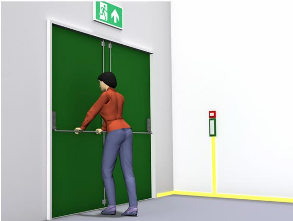
§ 11-14 Figur 6: Dør i rømningsvei i byggverk i risikoklasse 5 og 6 må kunne åpnes manuelt med ett grep og uten bruk av nøkkel.
