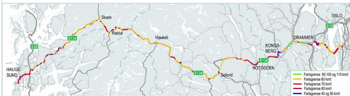
Figur 5.22 Oversikt over E134 Øst-vest forbindelse med fartsgrenser
