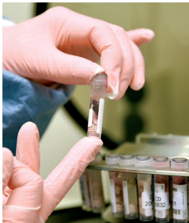
Fra spesiallab for prionsykdommer på Veterinærinstituttet. Prøver fra hjortevilt gjennomgår en rekke forberedende prosesser før de kan analyseres for skrantesjuka (CWD). Her skal prøvene gjennom en risteprosess for å bli flytende slik at de kan analyseres videre. Foto: Mari M. Press, Veterinærinstituttet
