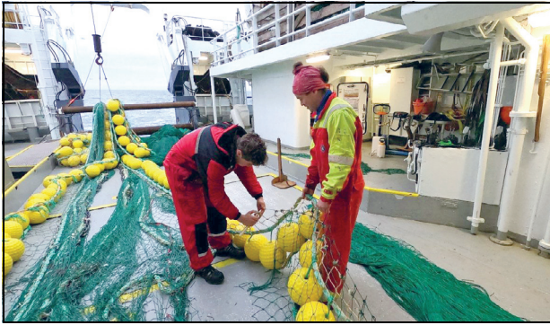
Figur 2.4 Økosystemtokt i Barentshavet, 2020. Utskifting av vingepanel på harstadtrålen - den tar forskarane «stikkprøver» av botnfisk med.
