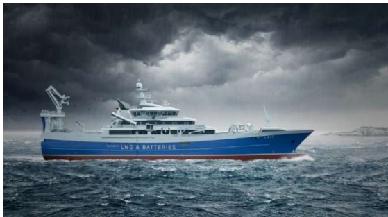
Figur 4-4 Fiskefartøy med LNG og batteri
