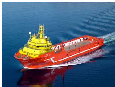
Figur 4-3 Offshoreskip med LNG og batterier
